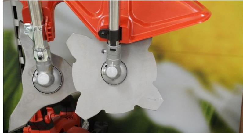
Motorsense: Diese beiden – üblichen – Modelle von Motorsensen arbeiten mit schnell rotierenden und sehr scharfen Metallscheiben. Je nach Form – dreizackig oder viereckig – sind die „Schneidezähne“ unterschiedlich lang. Der Haltestil läuft in schrägem Winkel an das Mähwerk, wodurch ein Unterschneiden möglich wird.
