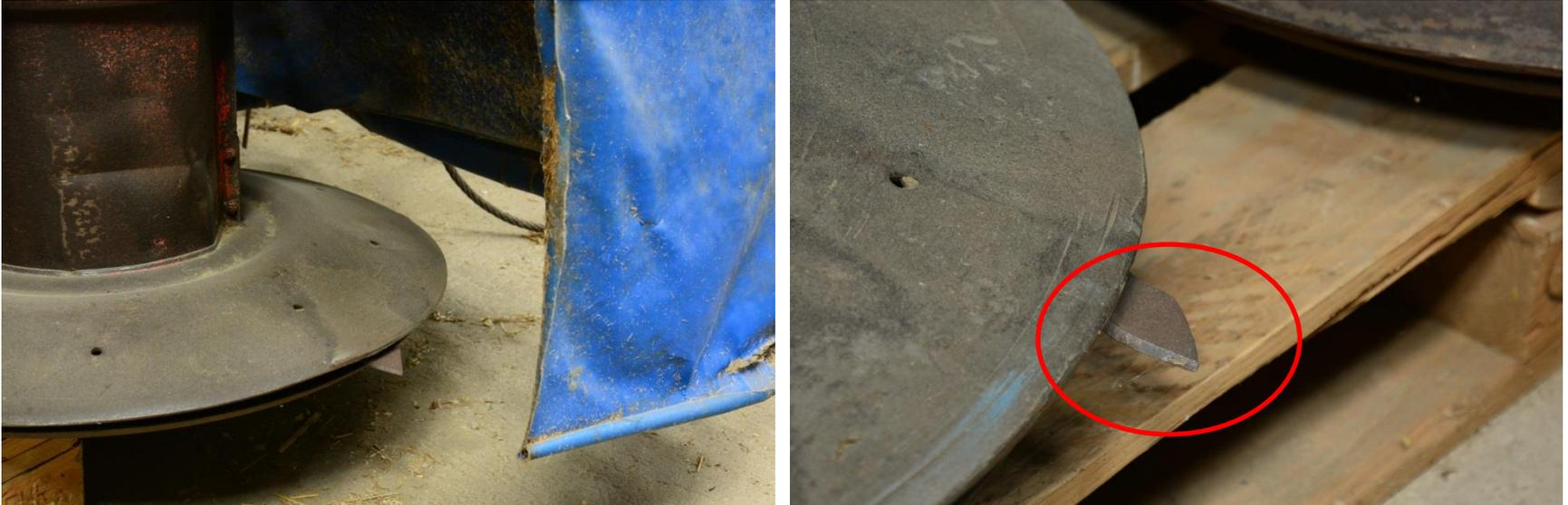
Mähwerk: Dieses Gerät ist seitlich oder hinter dem Traktor montiert und wird über eine Zapfsäule sehr schnell angetrieben. Das Fahrzeug bewegt sich mit hoher Geschwindigkeit. Die Messer ragen 3-4 cm aus der Scheibe. Durch Plastikvorhänge sind die rotierenden Messer geschützt.
