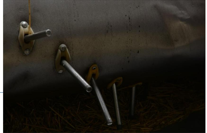
Die Schnitttiefe ist mit 5 – 7 cm vorgegeben. Durch die Walze wird das Mähgut zu den Klöppeln bewegt, wo der eigentliche Drusch erfolgt.
