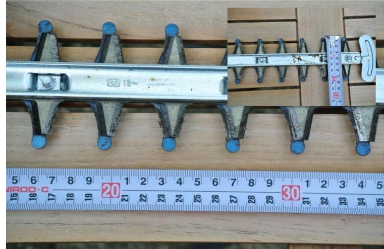
Heckenschere: Diese Geräte können mit Strom oder mit Verbrennungsmotor betrieben werden. Das Schwert ist relativ lang, die Schnitttiefe liegt bei 3 cm. Ein bodennahes Unterschneiden ist möglich.
